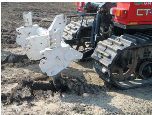
図1 サブソイラの施工
