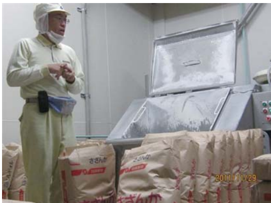
写真2 小麦粉投入口。
