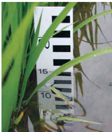
写真4 通常の水見板設置の様子
