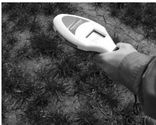
写真1 携帯型 NDVI センサ (GHCS) の測定の状況
