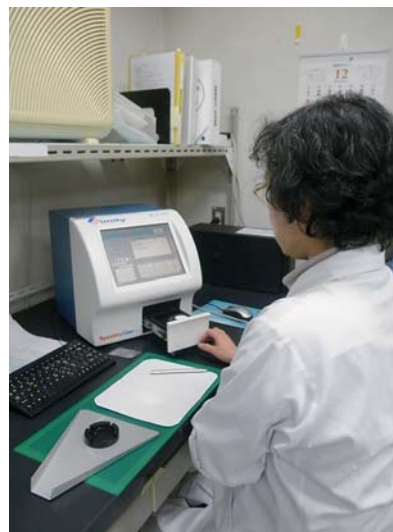
写真2：インフラライザーによるたんぱく質含有率測定の様子
